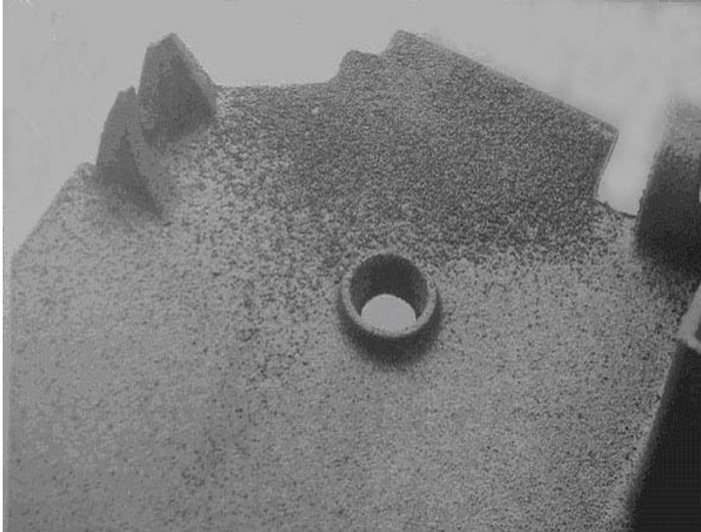
Resim 1.4: Sıvı metalin kuma işlemesi
