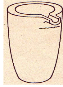
Şekil 4. Potanın gagaya asılı kalması sonucu pota ve dolgu maddesi ağırlığıyla oluşan çatlak.
