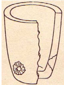
Şekil 6. Pota içerisinden bir darbeye meydana gelen koni şeklindeki çatlaklar.
