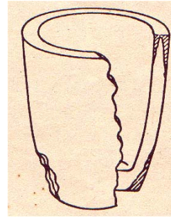
Şekil 17. Pota içindeki karbonlu maddelerin yanmasından veya oksitlenmesinden dolayı dökülme ve kabuk halinde kalkma alanları
