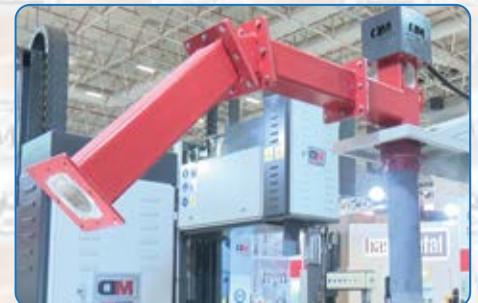
Fırından fırına, potadan potaya, fırından potaya ve fırından külçe kalıbına hızlı metal transferi Furnace - Furnace, Furnace - Ladle, Furnace - Mold Liquid Metal Transfer Application
