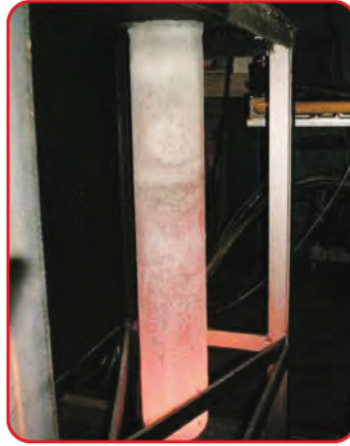
Ekatherm® Isıtıcı Tüpler Yüksek klor ergitmede üç hafta sonra Ekatherm® Heater Tubes In melting high chlorine 3 weeks later
