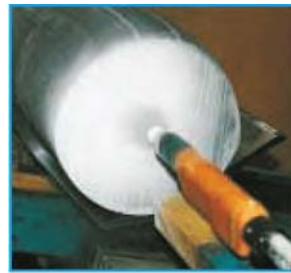
Biyetin Kaplanması Coating of the billet
