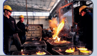
Kum Döküm Sand Casting
