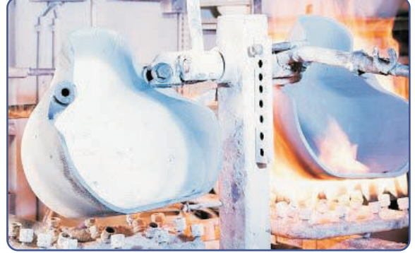
Ekamold® Cast C Alüminyum Bilet Sektörü için Boron Nitrit Kaplayıcılar Ekamold® Cast C Boron Nitride Coatings For Aluminium Billet Production
